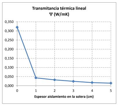
El aislamiento de la solera (al menos en su perímetro) no solo influye en la transmisión térmica hacia el terreno sino que también influye de forma relevante en la transmisión térmica hacia el exterior a través del puente térmico en el perímetro del edificio.
