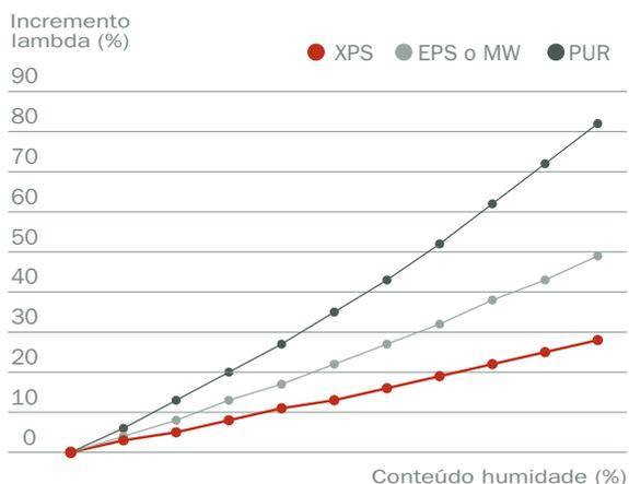
Na cobertura invertida, o isolamento encontra-se por cima da impermeabilização, o que vai fazer com que o isolante se molhe, por isso é necessário um material que, quando entra em contacto com a água, não diminua as suas propriedades, garantindo o isolamento térmico da cobertura em todas as situações.
