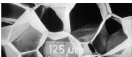
La estructura celular totalmente cerrada del poliestireno extruido le proporciona sus excelentes prestaciones frente a la absorción de agua y como aislante térmico. La elevada rigidez de la estructura celular dada por la gran homogeneidad de las celdas proporciona, a su vez, una altísima capacidad de resistencia mecánica.
